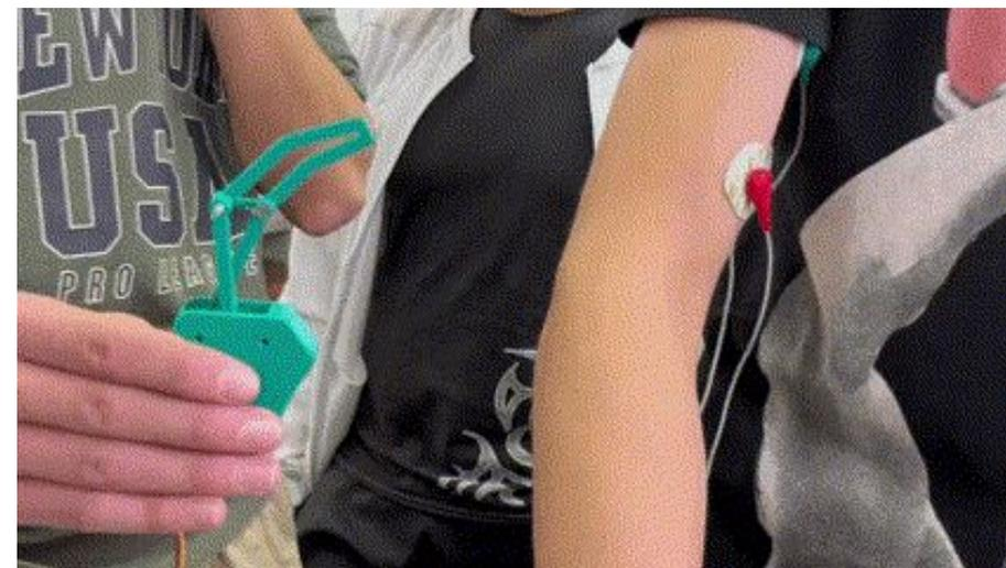
Miniaturizzazione del meccanismo proposto nel 2022 con l'introduzione di un sensore elettromiografico per comandare l'apertura o la chiusura del dito.
