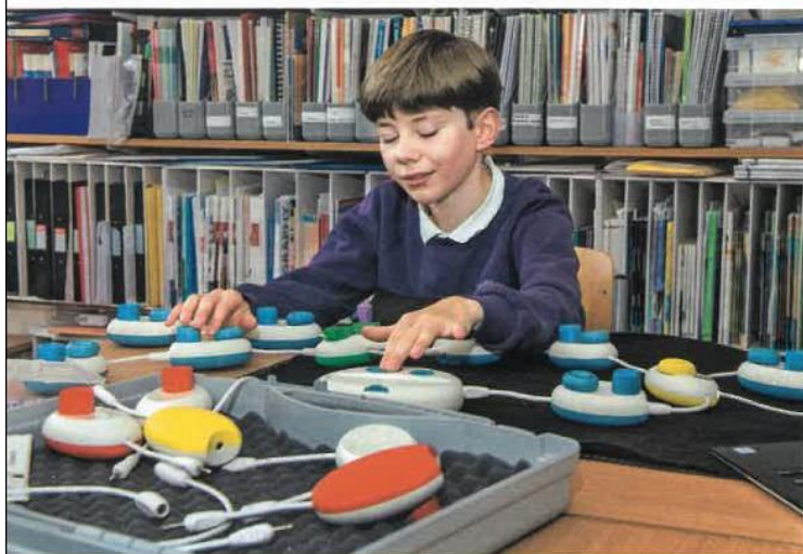
Sopra, un alunno non vedente mentre usa Code jumper, una rete di dispositivi a controllo tattile che insegnano la programmazione.
