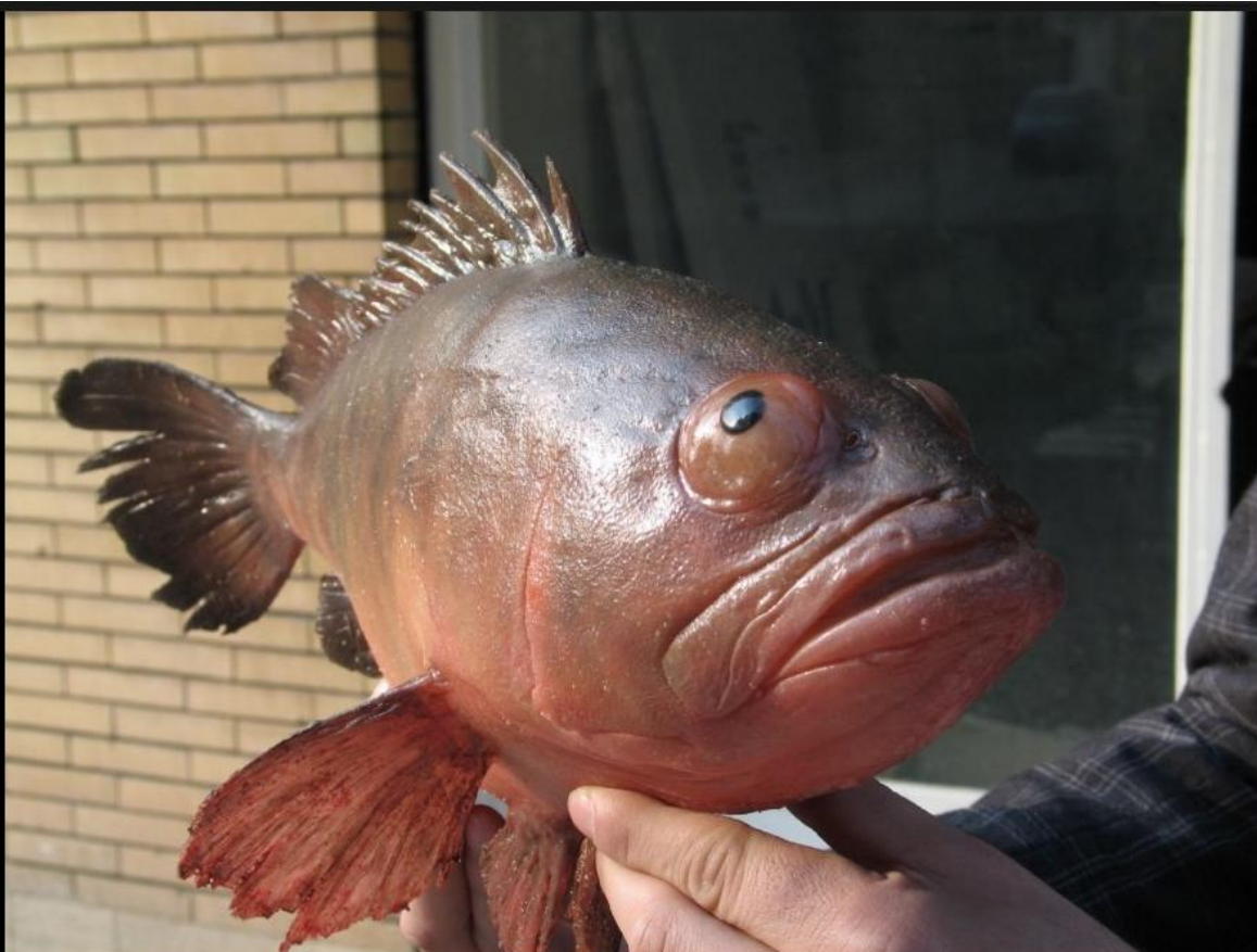
Pesce robot acquario di Roma - Il pesce robot di Expomed è costituito da una struttura meccanica, sensori e una pelle artificiale in lattice. Può essere "pilotato" dal pubblico attraverso appositi touch screen nelle vasche
