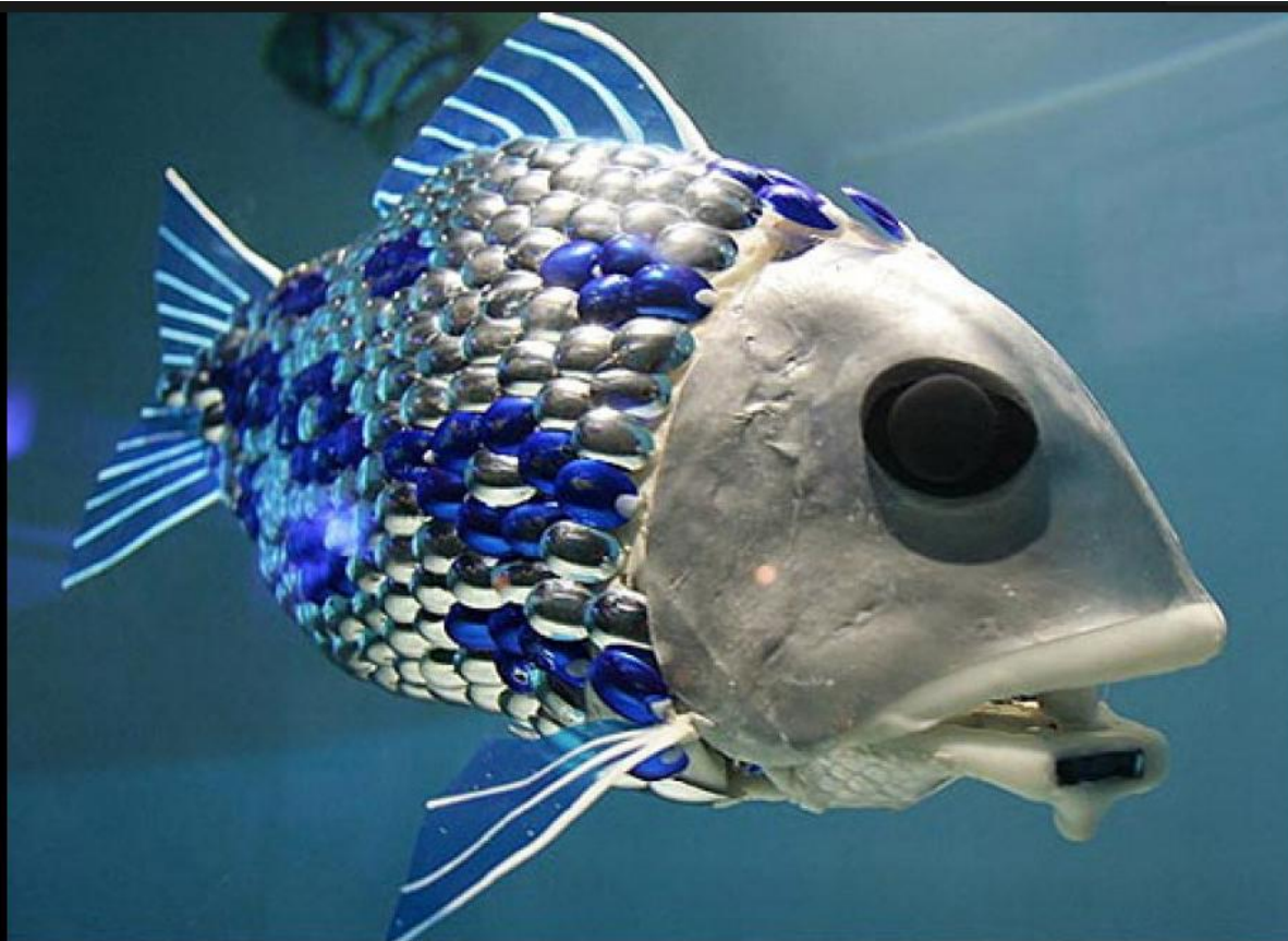
Pesce robot - Realizzato dal Campus Bio-Medico di Roma, è il primo prototipo di pesce robot completamente autonomo e in grado di riprodurre comportamenti e pattern motori tipici di alcune specie di pesci realmente esistenti
