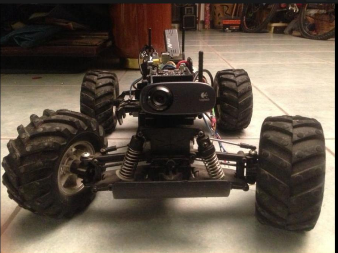
Robot in movimento - L'Istituto Gobetti di Bagno a Ripoli (FI) presenta due prototipi di veicoli a pilotaggio automatico, dotati entrambi di GPS, bussola e webcam
