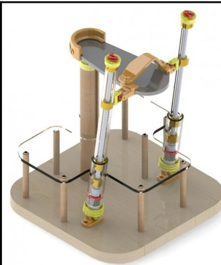
RiaTecnò - RiaTecnò (Rehabilitation Technology) è un progetto di robotica sviluppato dall'ITIS Vallauri di Fossano (Cuneo) per la riabilitazione del movimento del piede
