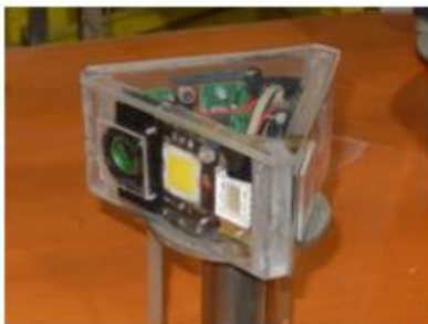
Particolare del modem ottico: testa luminosa omnidirezionale
