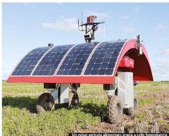
Un robot agricolo alimentato grazie a celle fotovoltaiche
